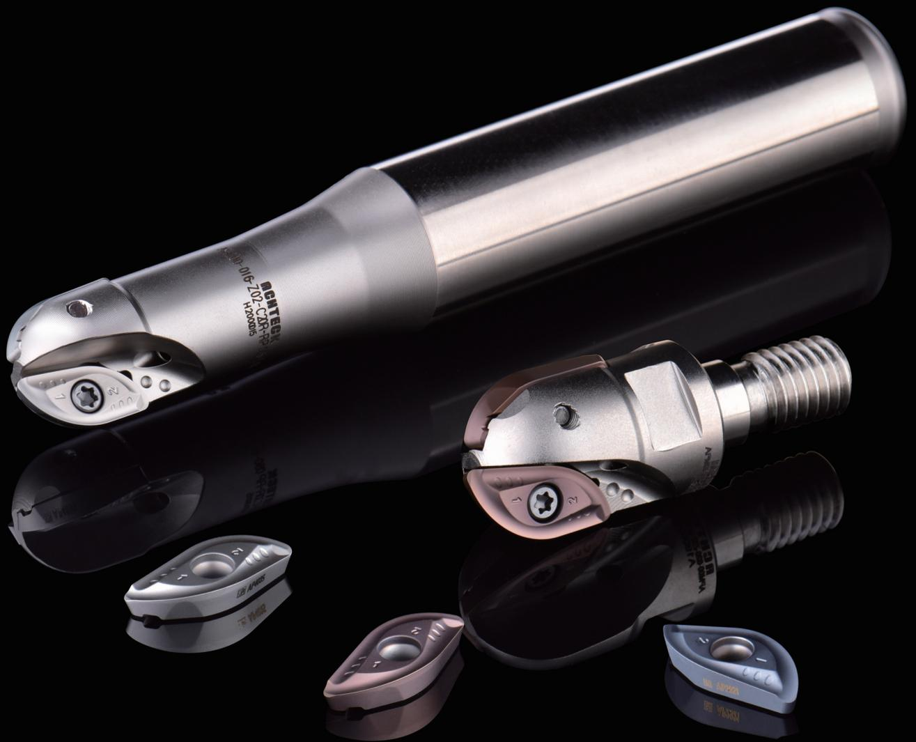
澳克泰工具全新推出的APM00-RPM系列仿形铣刀，该铣刀所用RPM系列刀片由于外形酷似植物中柳树叶子的形状，故而行业内也常叫做柳叶刀片。该铣刀主要应用于航空航天领域的叶片、叶盘的粗加工和半精加工以及模具模体的深腔加工。特别是在加工航空类材料如镍基合金、钛合金以及不锈钢材料上有杰出的表现，性能已经达到了国际一线品牌同等水平。
